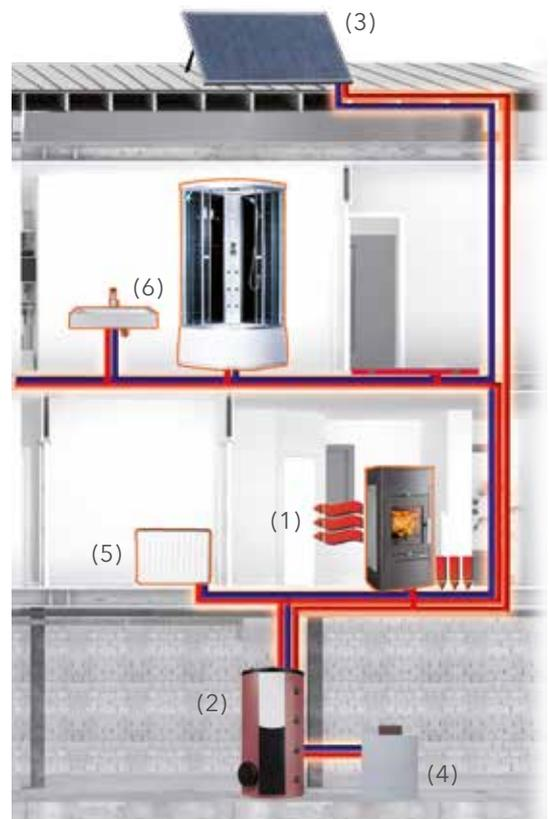
Ein Teil der Wärme wird für die direkte Raumbeheizung (1) verwendet. Der Rest wird von einem Pufferspeicher (2) aufgenommen, der auch von anderen Energiequellen wie Solaranlage (3) oder Heizkessel (4) beschickt wird. Je nach Bedarf wird die Wärme aus dem Puffer für die Einspeisung in die Zentralheizung (5) oder für die Trinkwassererwärmung (6) verwendet.
